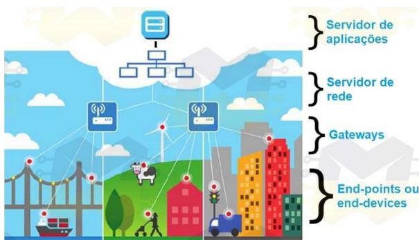
Figura 1. Arquitetura da Rede LoRa.
