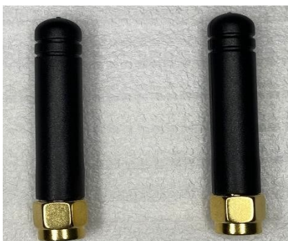
Figura 6. Antenas originais do Esp32 LoRa Heltec, 915mhz e 2dbi
